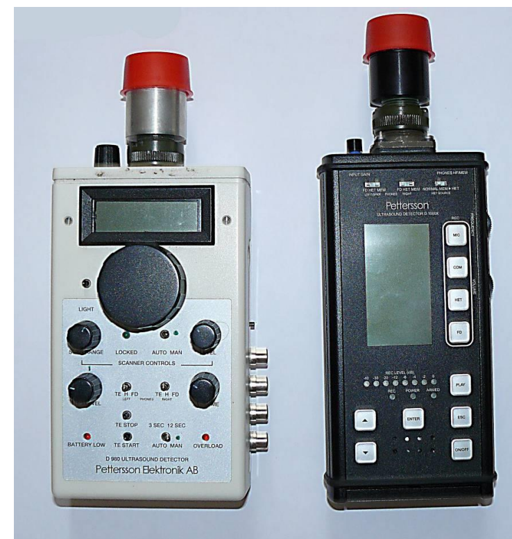
Détecteurs à ultra-sons, modèles D980 (à gauche) et D1000X (à droite) « Petterson elektronik » Photo : Cédric LOUVET - Ecosphère
